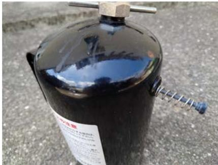
本体のノズル装着側へバルブ、スプリング (111) を取り付けます。
