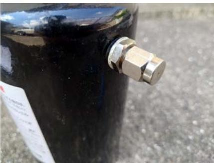
③の状態を維持しながら、ノズルセットにワッシャー (108) をかませてから、まず手で取り付けます。(時計回りに) その後、スパナ等にて締め付けます。
