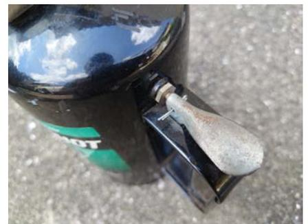
バルブにバルブトリガーをかぶせ、②同様にピンを通す。ピンが抜け落ちないように、ピンの先端を曲げる。
