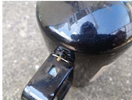
本体から出ているバルブの小さな穴に、ピンが水平になるよう通す。
