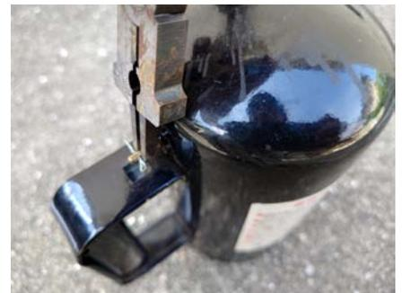
バルブのゴム側を指で押しながら、本体とピンの上にペンチなどを挟み、ペンチを右側へ押し付ける。
