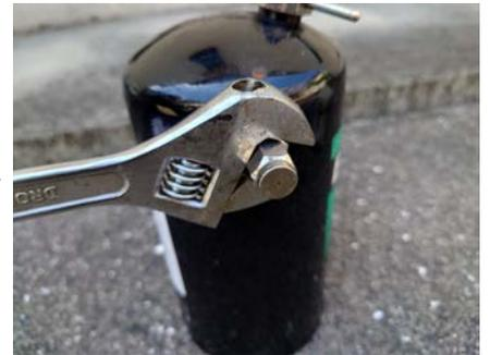
モンキーレンチ等でノズルセットを取り外す。(反時計回りにて)
