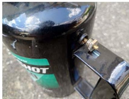
②で取り付けしたピンを外し、ナットを取り付け、スパナ等にて締め付けます。(時計回りに)
