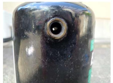
本体のノズル装着側より、内部の異物がないか確認。
