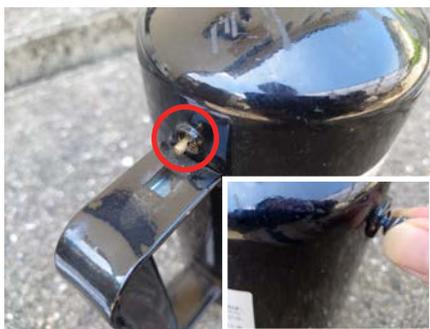
赤丸箇所、本体から出ているバルブを工具で軽くたたき、反対側よりバルブをひっぱり取り外す。
